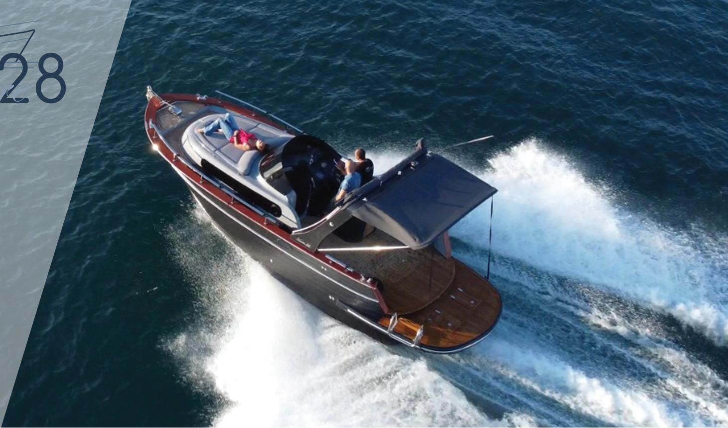
Il modello VENERE 28 Open Space è distinguibile per la presenza di una sovrastruttura applicata al parabrezza. Non si tratta di un tuna tower classico ma di una sorta di hard top rigido che alloggia tutta la strumentazione necessaria per le battute di pesca, inoltre protegge completamente la postazione di guida.
